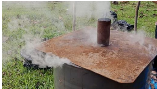
Gambar 7. Proses karbonisasi limbah serbuk kayu jati putih yang berlangsung selama \pm 7 jam
