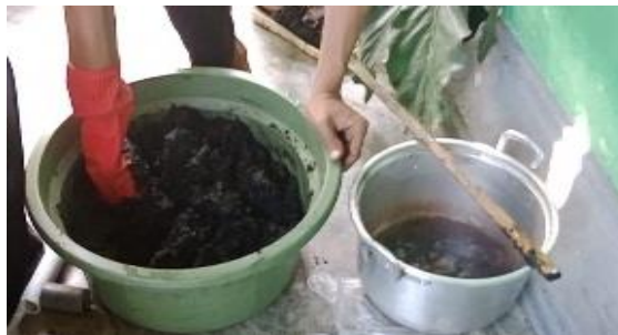
Gambar 9. Proses pencampuran arang aktif dengan bahan perekat (sagu)
