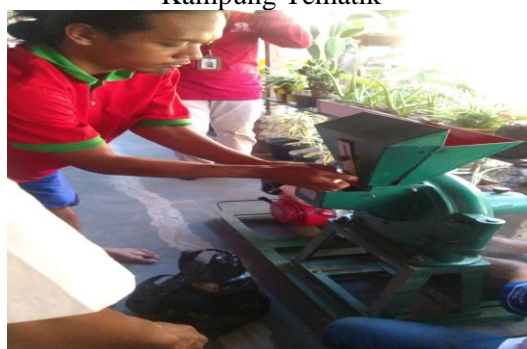
Gambar 7. Mesin pembuat tepung singkong bantuan dari LPPM Universitas Terbuka
