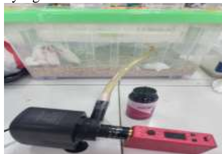
Gambar 1. Pompa udara aerator vakum dan tiup untuk uap rokok elektrik
