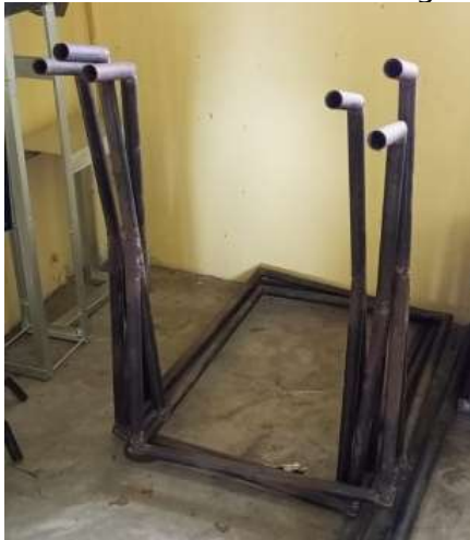
Gambar 4 Hasil Perakitan dalam Pembuatan Rangka
