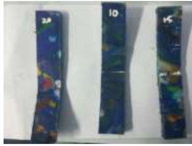
Gambar 8 Spesimen ASTM D 790
