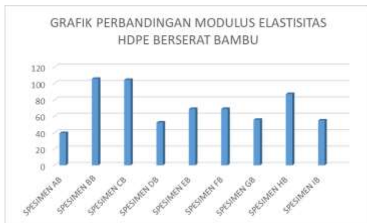
Gambar 9 Grafik Perbandingan Modulus Elastisitas HDPE Berserat Bambu
