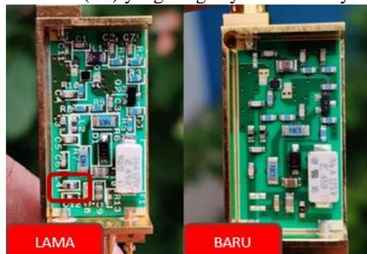
Gambar 1. Modul LNA lama (seri 11.15) dan LNA baru (seri 12.15)
