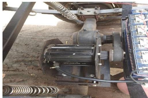
Gambar 15. Pemasangan Dinamo
