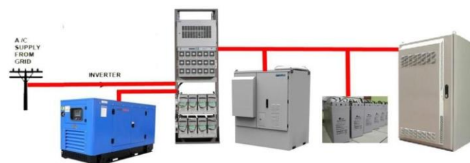
Gambar 2. Konfigurasi PLN dengan backup genset, fuel cell dan battery
