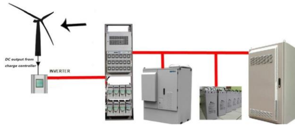
Gambar 3. Konfigurasi Wind generator dengan backup fuel cell dan battery
