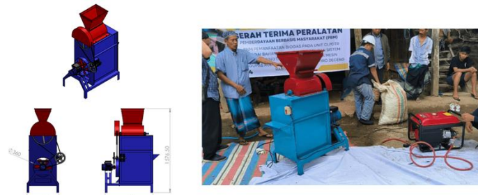
Gambar 2. Desain dan Mesin Pengupas Kulit Kacang
