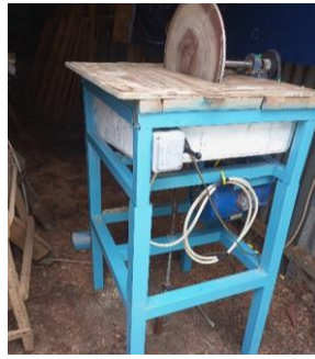
Gambar 8. Mesin amplas kayu hasil modifikasi
