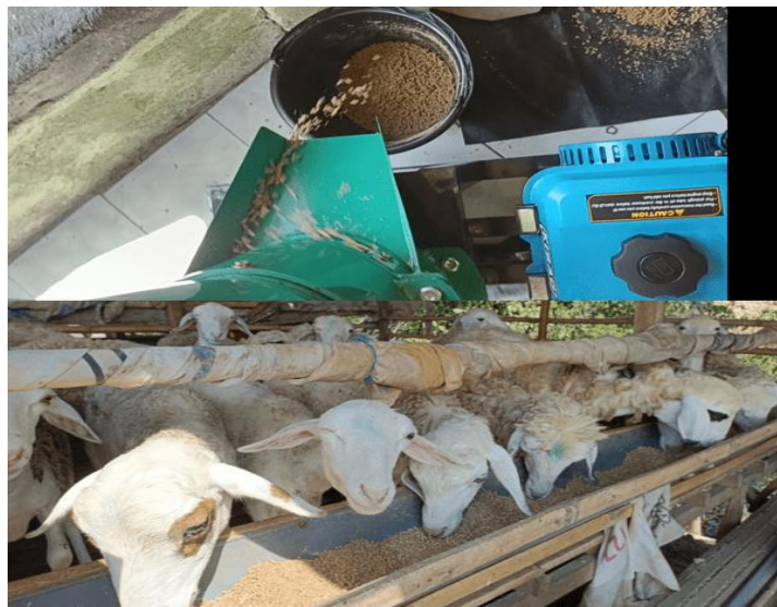
Gambar 4. Mesin pencetak green pellet dan proses pemberian pakan green pellet
