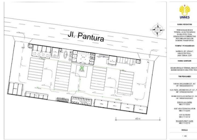
Gambar 3. Desain Layout Sirkulasi Kendaraan Terminal Angkutan Barang
