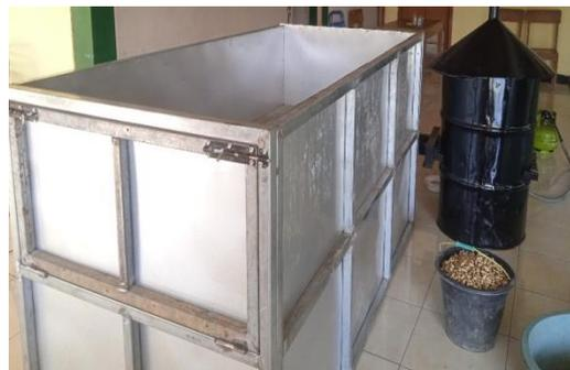
Gambar 3. Alat Pencuci dan Pengering Kacang Tanah
