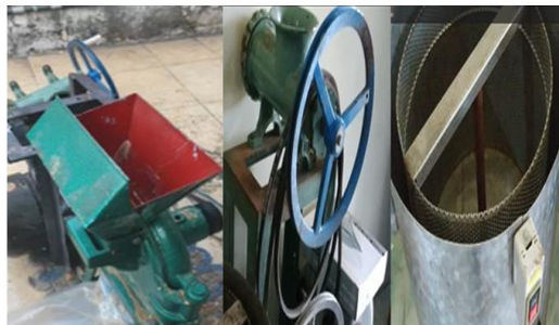
Gambar 5. Mesin penepung, Mesin pencetak pelet dan Mesin pengering pada proses pembuatan Pakan Ikan alami Mandiri
