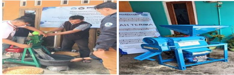
Gambar 4. Modernisasi sistem produksi melalui penerapan Mesin Penggiling dan Pemecah Jagung
