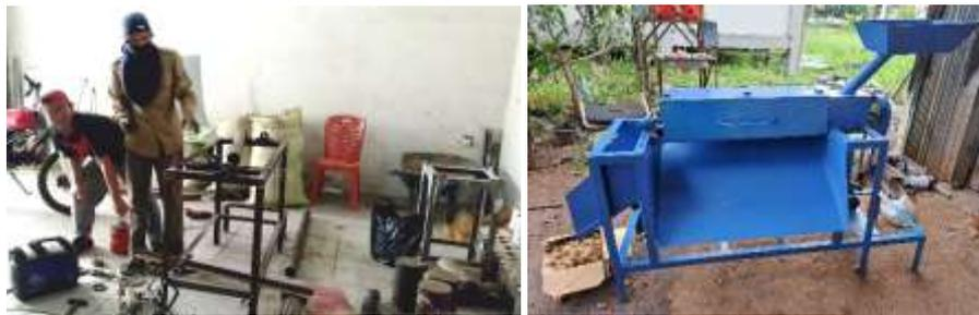
Gambar 7. Pembuatan Mesin Pengupas Sabut Buah Pinang
