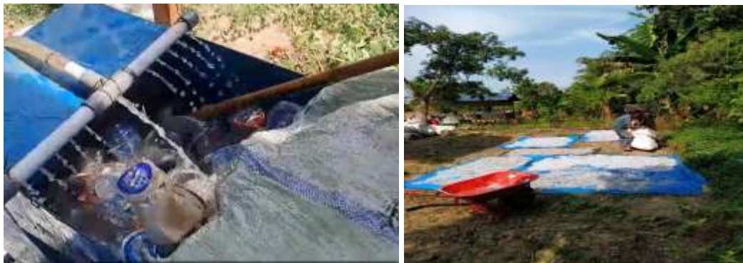
Gambar 8. Hasil Uji coba Mesin Pencacah plastik jenis crusher (a) Proses Pencacahan (b). Pencucian dan pembilasan (c) Hasil pencucian dan potongan plastik (d). Penjemuran hasil pencacahan plastik
