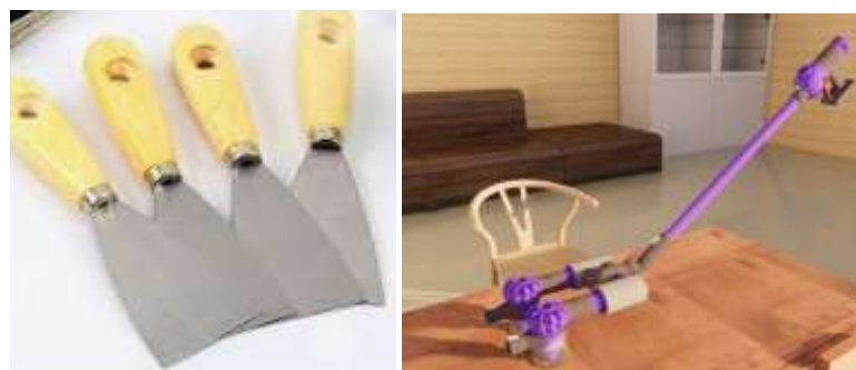
Gambar 4 Desain Perbandingan Sarana Pembersih Kapal Konveksional dan Inovasi Yang Diberikan
