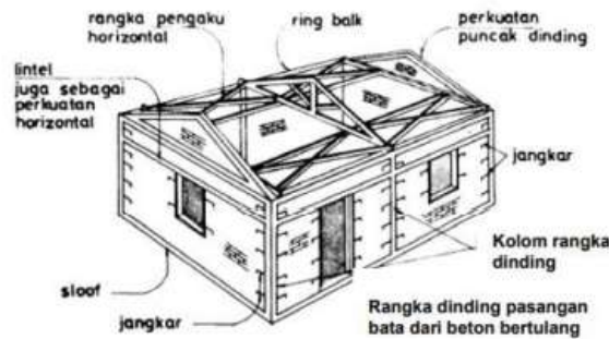
Gambar 5. Rangka Sederhana Konstruksi Rumah Tinggal
