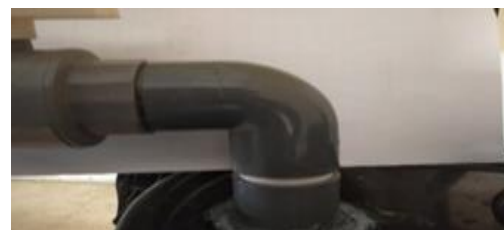
Gambar 4. Paralon ini digunakan sebagai lubang isi ulang Biogas dan sambungan pipa L
