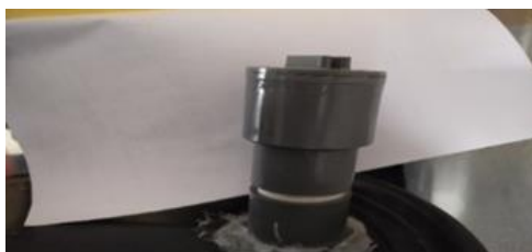
Gambar 4. Paralon ini digunakan sebagai lubang isi ulang Biogas dan sambungan pipa L
