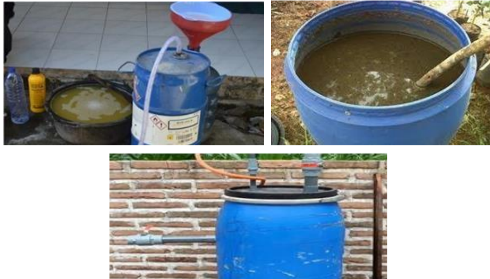
Gambar 7. Limbah Cair Tahu yang telah Dimasukkan dalam Drum Digester
