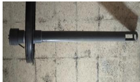
Gambar 2. Drum yang di lubangi pada 2 bagian Paralon yang digunakan untuk pengisian biogas.
